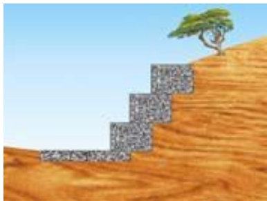
Rys. 2. Przykład wykorzystania koszy gabionów do budowy ścian oporowych (a), oraz kurtyn skalnych (b) [3]
